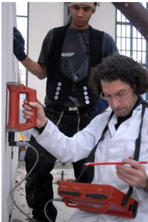
Bewehrungssuche mit dem FerroScan
